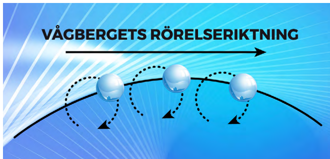
Vattenmolekylerna rör sig medurs i cirklar med diametern lika med våghöjden. Vågberget rör sig då åt höger.
