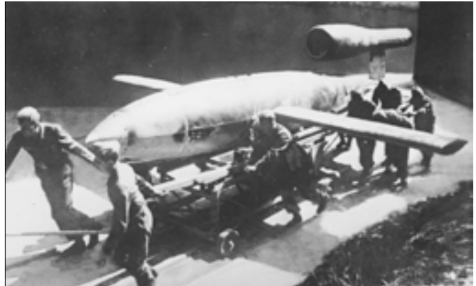
Figur 5. Nazitysklands robotvapen V1 med smeknamnet 'Doodlebug', drevs framåt genom pulsförbränning liknande den hos bombarderbaggan.
