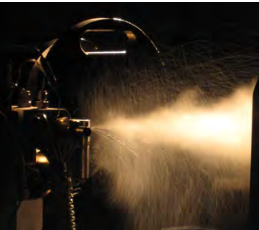
Figur 6. Experimentell prototyp för att spreja små droppar av vätska och ånga med bombardierbaggen som förebild.
